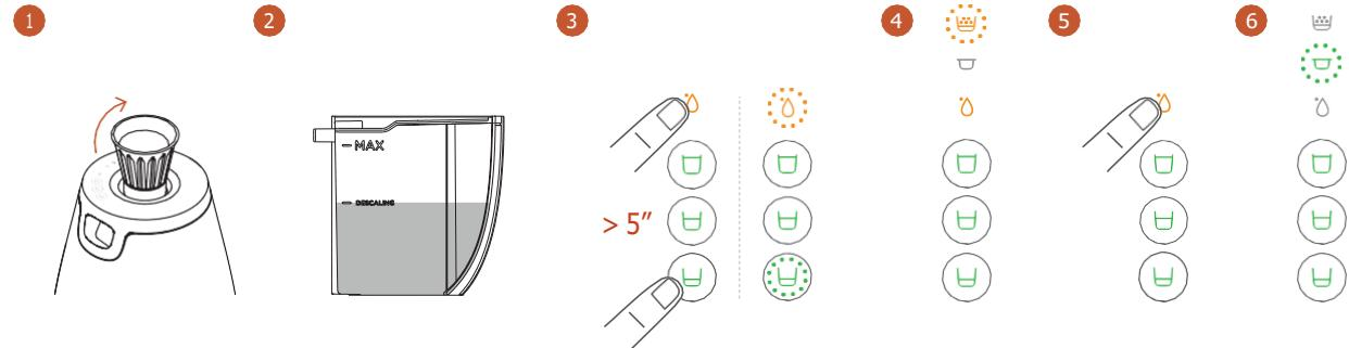
Se recomienda que realice la descalcificación del equipo cada 1000 extracciones. La alerta de descalcificación es automática. El Sistema de Limpieza se mantiene en naranja. Todos los botones de extracción permanecen en verde.
