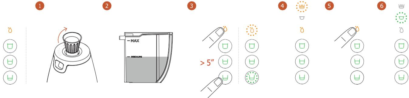
Il est recommandé de réaliser le détartrage de l'appareil tous les 1000 extractions. L'alerte de détartrage est automatique. Le voyant du bouton Système de nettoyage devient orange.
