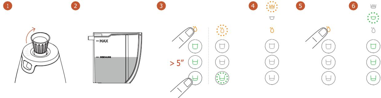
É recomendado que realize a descalcificação do equipamento de 1000 em 1000 extracções. O alerta de descalcificação é automático. O Sistema de Limpeza fixa em laranja. Todos os botões de extracção permanecem fixos em verde.
